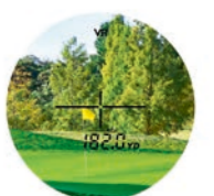
测量到背景树林的距离时的取景器模拟图
