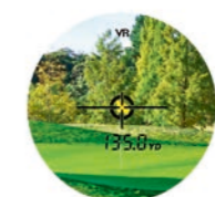
测量到以树林为背景的旗杆的距离时的取景器模拟图
